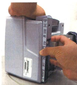
4. Si le module DI est lâche ou si l'écran est vierge, cessez d'utiliser la pompe à perfusion. Relevez le numéro de série et contactez le service d'assistance technique d'ICU Medical. Sinon, la pompe à perfusion peut être remise en service.
