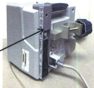
3. Vérifiez que le module DI n'est pas lâche en tenant la pompe vers le bas d'une main et en tirant fermement sur le module.
